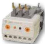
Sobrecargas electrónicas utilizan tecnología de estado sólido para detectar sobrecargas y pérdidas de fase, así como inversión de fase y desbalances. Con un amplio rango de sobrecargas y punto de disparo seleccionable por el usuario. Tres tamaños de marcos que protegen motores de 0.3-85ACA. Tipos de montaje: directo, separado y a través de orificios.
