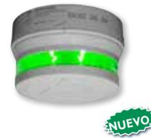
Indicador LED para montaje fuera del cajón de estacionamiento. Luz brillante LED RGB con indicación de espacio a 360° (multicolor) integrada. Base de soporte para cuneta de cables, guías de montaje de techo y tubería. Se alimenta del bus de 3 hilos Dupline®
