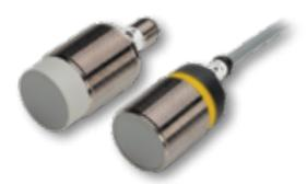
Sensor inductivo de proximidad M30 en acero inoxidable, latón niquelado o plástico con cubierta IP67. Versión estándar y de rango triple hasta 22mm de sensado. Salidas NAMUR, 2 hilos CA, 2 hilos CD y 3 hilos CD. Montajes rasante, cuasi-rasante y no rasante. Método de conexión: cable 2m o conector M12. Versiones IO-Link de estos sensores se muestran en la pág. 11.
