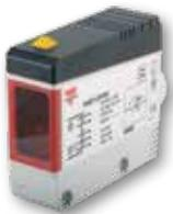
Tamaño de rango completo en sensores CA/CD o CD con cubierta plástica reforzada. Tipos: Difuso (0.8m), retro-reflexivo (10m), polarizado (12m) y barrera (20m). La función de sensado puede ser verificada a través de una entrada mute ideal para aplicaciones de puertas industriales.
