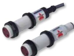
Voltaje de alimentación de 20 a 250VCA. Cubiertas de latón niquelado o plásticas, IP67. Difuso (400mm), polarizado (2m), retro-reflexivo (3m) con inmunidad a superficies reflejantes. 2-hilos, Salidas NA o NC SCR. Cable PVC de 2m o conector M12.
