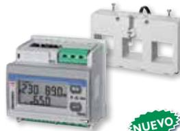
Analizador de potencia multi-circuito para 6 sistemas monofásicos o 2 trifásicos, montable en panel o riel DIN. Mide corrientes mediante dos bloques transformadores de corriente TCD. El **EM270** está equipado con un display LCD removible. Opcional: puerto RS485 o salida de pulsos. Máx. Voltaje de 415 VLLCA.
