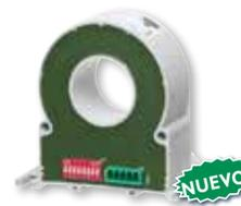
La familia **CPA** de analizadores de potencia y transductores de corriente para monitoreo de instalaciones monofásicas CA o DC. La corriente se mide mediante el transformador incluido, mientras que para el voltaje se requiere conexión por cables. El CPA mide hasta 300ACA/400ACD y 800VCA/1000VCD. Cuenta con Modbus RS485 como estándar.
