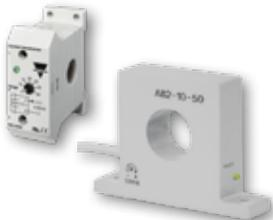
**E83** Medición compacta de corriente CA con 7 rangos seleccionables hasta de 50ACA y orificio de 12mm. También en versión con cable tipo **A82** en rangos primarios de 25, 50, 100, 250 y 500ACA. Rango primario con salida de 4-20mA o 0-10V. Orificio de 27mm.
