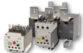
Sobrecargas bimetalicas GT se acoplan directamente a todos los modelos de contactores CC y protegen a los motores de sobrecargas y pérdidas de fase. Siete tamaños de marcos disponibles para rangos de 0.1-800ACA. Disponibles modelos de montaje directo o separado.
