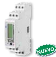
El **VMU-MC** es un concentrador de pulsos que permite integrar totalizadores a sistemas como **VMUC-EM**. Controla hasta tres **VMU-OC** a través de un bus local para integrar de 2 a 11 entradas digitales. Cada **VMU-MC** tiene dos entradas digitales, mientras que el **VMU-OC** ofrece tres.
