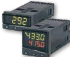
Controlador PID 1/32 DIN con una línea de display (**T2032**) con alimentación en CA o CD, salidas de relé y comunicación serial. Controlador PID 1/16 DIN con dos líneas de display (**T2016**), alimentación en CA o CD, operación calentamiento/enfriamiento y entradas universales. La versión T2016P permite múltiples modos de rampas.
