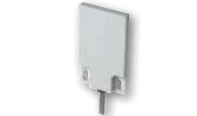
Sensor capacitivo de nivel de 3 hilos CD con colector abierto y salida a transistor NPN o PNP. Distancia de detección fija y detección a través de paredes no metálicas de hasta 25mm de grosor. Ideal en la detección a través de tubos.
