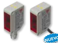
Sensor compacto con cubierta versátil IP69K, listo para montaje lateral por tornillos, o montaje frontal con barril de 18mm. Ajuste de potenciómetro, disponible en modos de detección: difuso (1m), supresión de fondo (200mm), polarizado (5m), retro-reflexivo (6.5m), barrera (20m). Cable PVC de 2m o conector M12.
