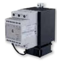
Los controladores de estado sólido **RGC2/3P** permiten un control proporcional de la salida. Este dispositivo controlado por microprocesador ofrece varios modos de conmutación tales como: ángulo de fase, distribución de ciclo completo o arranque suave. Máximo nivel de corriente es de 75ACA (**RGC2P**) y 65ACA (**RGC3P**), es controlado por varios tipos de señales análogas en la entrada.
