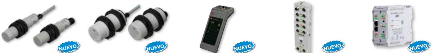
Los sensores Capacitivos M18 y M30 con IO-Link son configurables y fácilmente programables vía IO-Link: tipo de salida seleccionable (PNP/NPN/ Push-pull, NA/NC), temporizador, compuertas lógicas, inversor de salida, alarma de polvo, teach externo y diagnósticos. Los sensores ofrecen 2 salidas (una puede ser programada para ser entrada). Cable PVC de 2m o conector M12. IP69K, ECOLAB y operan a temperaturas entre -30 y 85°C / -22 a 185°F (la cara soporta 120°C / 248°F)
