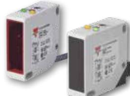
Sensores compactos de rango completo CA/CD o CD en cubierta de plástico reforzado. Difuso (1m), supresión de fondo (500mm), retro-reflexivo (10m), polarizado (6m) y barrera (20m). El amplio rango de sensado y ajuste de sensibilidad lo vuelven bastante flexible.
