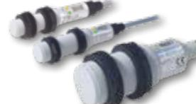
Sensores capacitivos tecnología Tripleshield™ y botón "teach". Rangos de sensado de hasta 8mm (M12), 12mm (M18) y 30mm (M30). Salidas de 4 hilos CD NPN o PNP NA/NC. Conexión por 2m de cable o conector M12. Compensación de humedad auto-detección NPN/PNP, calibración remota, salida de alarma. Compensación de polvo o humedad opcionales.
