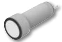
Sensor ultrasónico multifunción M12 con cubierta IP65 de acero inoxidable. Distancia de detección de hasta 200mm. Salida NPN o PNP con selección remota de NC o NA. Conector M12.
