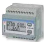
Analizador de energía trifásico **EM210** con display frontal removible LCD. Se puede montar en panel o riel DIN. Las mediciones de corriente se hacen mediante un transformador de corriente externo de 5A (CTD), 333mV (CTV) o **ROG4K** (bobina Rogowski). Salida de pulsos o puerto RS485 también están disponibles. Máximo Voltaje de 415VLL CA.
