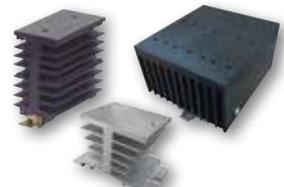
Los disipadores de calor **RH** son accesorios indispensables para cualquier relé de montaje tipo chasis con conmutaciones mayores a 5A. Disponibles para montaje en riel DIN, panel y a través de pared; de uno o múltiples RES. La oferta de productos disipa desde 4.0 hasta 0.12°C/W. También se ofrecen ventiladores opcionales.
