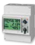
Analizador de energía trifásico para montaje en riel DIN con display LCD y joystick de configuración. El **EM24** requiere transformadores de corriente **CTD** de 5A. Puede tener 2 salidas o 3 entradas digitales (conteo de pulsos). Opciones de comunicación Modbus RTU o Modbus TCP/IP Ethernet. Voltaje máx. 690VLLCA en algunos modelos.
