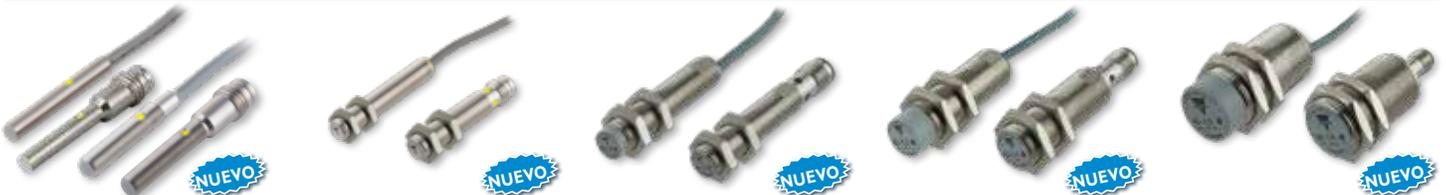
Los sensores Inductivos de proximidad Ø4mm, M5, M8, M12, M18 y M30 con IO-Link son ajustables y fácilmente programables a través de comunicaciones IO-Link: Salidas PNP/NPN/ Push-pull, NA, NC y ofrece funciones como temporizador y divisor, contador RPM, monitoreo de velocidad rotacional y diagnósticos. Las versiones Ø4mm, M5 y M8 se ofrecen con cable PVC de 2m o conector M8, mientras que las versiones M12, M18 y M30 se ofrecen con cable PVC de 2m o conector M12.
