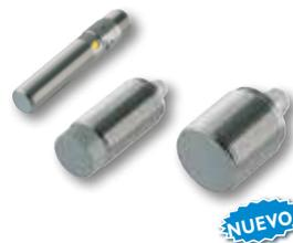
La **serie ICS** para ambientes hostiles en tamaños M12, M18 y M30 con cubiertas de Acero inoxidable, IP69-K y certificación ECOLAB, soportan de -40°C a 80°C (-40°F a 176°F). Con rangos de sensado de hasta 22mm. Salida de 3 hilos en CD. Montaje rasante o no-rasante. Conector M12 o con la **Serie CONB** IP69-K.
