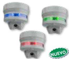
Sensor ultrasónico con detección angular de 45° para montaje en la entrada del cajón de estacionamiento. Luz brillante LED RGB con indicación de espacio a 360° (multicolor) integrada. Base de soporte para cuneta de cables, guías de montaje de techo y tubería. Se alimenta del bus de 3 hilos Dupline®
