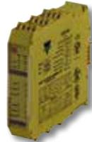
El módulo CERTUS controlador de velocidad permite monitorear y controlar la velocidad cero, la velocidad máxima, el rango de velocidad y dirección. Hasta 4 umbrales de velocidad configurables. Hasta 2 salidas, para control de 2 ejes independientes.
