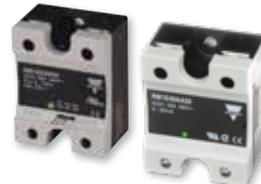
El relé de conmutación análoga trabaja de acuerdo al principio de control de ángulo de fase. Donde el punto de conmutación en la onda senoidal depende de la entrada proporcional que puede ser de 4-20mA o de 0-10VCD. Cuatro niveles de salida de 25, 50, 75 y 100 ACA y hasta 660VCA.
