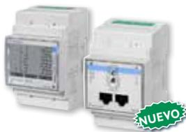
El medidor de energía **EM330** y el transductor de energía **ET330** están diseñados para medición de energía activa a un costo accesible. Diseño para montaje en riel DIN. El transductor cuenta con puertos RS485. Ambos requieren transformadores de corriente de 5ACA. Voltaje Máx. 480VLLCA
