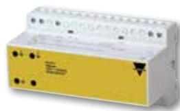
Gateway pasivo con mapeo se monta en riel DIN y lee/controla hasta 128 entradas/salidas mediante Profibus-DP. También se ofrece un repetidor aislado DuplineSafe para extender la distancia de transmisión. Pueden conectarse en cascada.
