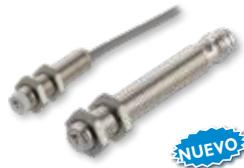
Sensor inductivo de proximidad en cubierta M8 de acero inoxidable, IP67. Rangos de sensado estándar y extendidos de hasta 4mm. Opciones NAMUR, 2 hilos de CD y 3 hilos de CD. Montaje rasante y no-rasante. Conexión a elegir entre cable de 2m, o conector de M8 o M12. Versiones IO-Link de estos sensores se muestran en la pág. 11.
