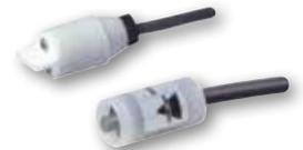
Varillas conductivas de sensado de nivel. Varilla suspendida para control de un punto (ej. piscinas). Conexiones de cable en neopreno. El **A94** tiene dos varillas en una parte separadas por una barrera aislante de poliéster. Las funciones de detección se determinan según el amplificador usado.
