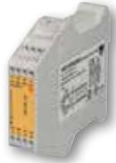
Relé de seguridad de propósito dedicado para compuertas de seguridad y aplicaciones de sensores magnéticos de seguridad. Cumple con EN60204-1, EN292-1/-2, EN418 y EN1088. Categoría 4, Rendimiento nivel "e". Versión automática/manual y disponible con reset de monitoreo manual.
