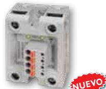
La Serie **RK** de Relés ES de dos polos en un solo paquete con la posibilidad de controlar cada polo de manera independiente (**RKD2**) o ambos polos simultáneos (**RK2**). Valores de hasta 660VCA, 75ACA por polo. Las opciones de conectividad incluyen un conector de cable macho de 2.54mm o una terminal de resortes 5.08mm.
