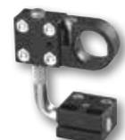
Herraje de montaje universal para cualquier sensor cilíndrico de Ø4 a Ø30mm. El adaptador incluye 2 cabezas de montaje (Ø18 y Ø30mm) y 5 casquillos adaptadores (Ø4, Ø5, Ø8, Ø12 y Ø14 mm).
