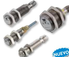
Las series **ICB** e **ICS** con salida complementaria otorgan alta flexibilidad. Se ofrecen en cubiertas IP67 M8 (acero inoxidable), M12, M18 y M39 (latón niquelado). Sensado estándar y extendido de hasta 22mm
