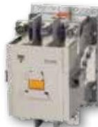
Contactores robustos de 3 o 4 polos con AC3 nominal de 130-800ACA a 480VCA, certificación cUL de 45-600Hp. Dos sets de contactos auxiliares, sobrecargas, interlocks reversibles. Bobinas de CA, CD y CA/CD disponibles.
