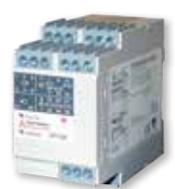
Transductor compacto trifásico para la medición de las principales variables eléctricas en tableros de máquinas. Diseño para montaje en riel DIN con hasta 3 salidas análogas, comunicación RS485, puerto de salidas de alarma o "Dupline" bus. Voltaje máx. 800VCA.
