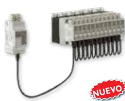
El **NRG** es un sistema que consiste de un controlador maestro y hasta 48 **RG..N** relés/contactores de estado sólido esclavos. La interfaz Modbus RTU permite lecturas por relé de valores instantáneos y consumo de energía. El **RGS1A..N** trabaja hasta 90ACA con el disipador adecuado, mientras que el **RG1..N** trabaja hasta 65ACA con disipador integrado.
