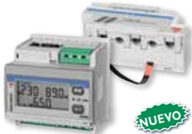
Analizador de potencia multicanal para 6 sistemas monofásicos o 2 trifásicos. Instalación en panel o riel DIN. Su entrada de corriente soporta 32ACA vía un bloque de TC de 6 canales (**TCD06BS** o **TCD06BX**) con conexión RJ-11. El **EM280** está equipado con un display LCD removible. Voltaje máx. de 415VLL CA
