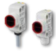
Sensores con carcasa pequeña y versátil IP69K, montaje lateral con tornillos, o montaje frontal con barril roscado de 18 mm. Ajuste del potenciómetro, disponible en difuso (1m), supresión de fondo (200mm), polarizado (5m), retro-reflexivo (6.5m), barrera (20m). 2m de cable PVC o conector M12.
