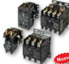
Rango de contactores básicos que se ofrecen en configuraciones de un polo, un polo + shunt, dos y cuatro polos normalmente abiertos para cargas de 25-40ACA máximas en AC3, con terminales de zapata o tornillo y en tres polos de 25-90ACA con terminales tipo zapata. También hay terminales de control y carga de 0.25" faston
