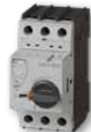
Arrancadores manuales de motor combinan la funcionalidad de un relé de sobrecarga bimetalico con protección magnética contra cortocircuitos. Disponible en tres tamaños de marcos para cargas completas de 100ACA y protección de cortocircuito hasta 100kA, con adaptadores disponibles para conexión directa a la serie CC de contactores desde 9 hasta 100ACA.
