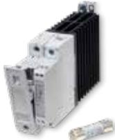
El **RG1..F** combina tres funciones en una: conmutación, protección del circuito mediante un fusible semiconductor integrado y opcionalmente monitoreo del sistema. El Panel frontal se puede abrir para un acceso sencillo del fusible. El porta fusible acepta modelos de la mayoría de los fabricantes. Alarmas indicadas mediante LED rojo y salida auxiliar de alarma. Corriente nominal hasta 40ACA.
