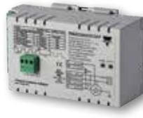
Arrancador suave para compresor tipo scroll de 1 fase con capacitor de arranque integrado. **RSBS** también está disponible en tamaño estándar 25A y alta presión 32A, esta última suministra una corriente dinámica limitante que asegura el arranque del compresor aun a presiones mayores de arranque con un límite máximo de corriente de 80ACA.
