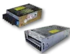
Compacta y de gran potencia. Fuentes cerradas de 25, 35, 50, 75, 150, 200, 240, 320, 480, 600 y 800W con ventiladores incluidos (>150W) con control de velocidad, así como CFP activo (>150W). Cuentan con entrada universal CA/CD, alta eficiencia, consumo de potencia muy bajo en tiempo de espera y un alto MTBF. Sus voltajes de salida son 5, 12, 15, 24, 36 y 48VCD.
