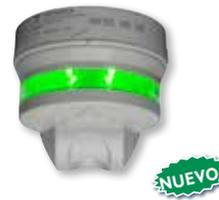
Sensor vertical para montaje en el carril de entrada/salida para conteo. Luz brillante LED RGB con indicación de espacio a 360° (multicolor) integrada. Base de soporte para cuneta de cables, guías de montaje de techo y tubería. Se alimenta del bus de 3 hilos Dupline®
