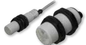
Sensores capacitivos con la tecnología mejorada Tripleshield™ de 4<sup>a</sup> generación (mayor compensación a polvo y humedad). Cubiertas con aprobación ECOLAB IP69K y resistencia de hasta 120°C (248°F) en su cara de sensado. Rangos de sensado de hasta 12mm (M18) y 30mm (M30). Salida a 4 hilos NPN o PNP NA o NC. Con 2m de cable o conector M12. Salidas de alarma para polvo o temperatura opcionales.
