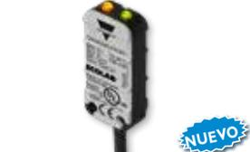
Diseño compacto (34x16x8mm) ideal para la detección de líquidos basados en agua. La función de Supresión de Fondo ignora suciedad, humedad y espuma que se crea debido a ciertos líquidos. Salidas a escoger NPN o PNP, NA o NC. Disponible con cable de 2m o salida tipo 'pigtail' con conector M8. Cuerpo aprobado por ECOLAB IP69K
