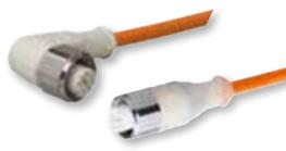
Cables IP69K con certificaciones UL y ECOLAB. Resistencia a químicos y agentes de limpieza que los hace ideales para la industria alimenticia. Rango de temperatura hasta 90°C (194°F). Para sensores de CD. Conector M12 de 4 pines disponible en ángulo recto o de 90°, en longitudes de 2m o 5m.
