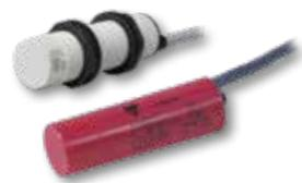
Sensores capacitivos de proximidad para aplicaciones de temperaturas extremas. Rango de operación a temperaturas de -196°C a 180°C (-321°F a 356°F). Rango de sensado 4-15mm (no-rasantes). Salidas NPN o PNP NA/NC. Ideal para secadoras o mezcladoras en la industria plástica.
