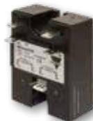
Relé ES de dos polos minimiza los requerimientos de espacio sin sacrificar su desempeño. Dos RES en una sola unidad Hockey Puck **RA2A**. Salida de hasta 40ACA por polo y hasta 660VCA. Terminales tipo pestaña de 0.25" para cableado rápido. Opción de modelo pestaña o pines para voltaje de entrada.
