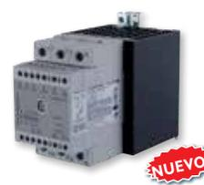
Los contactores de estado sólido **RGC2A** y **RGC3A** están disponibles con la opción de monitoreo de sistema que ofrece detección del sobrecalentamiento, pérdida de fases o cargas. El RGC2/3..M cuenta con LEDs para indicar alarmas y carga, así como una alarma de transistor y salidas auxiliares. La opción de monitoreo está disponible en la mayoría de los dispositivos **RGC2A** y **RGC3A**.
