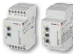
Controlador de nivel multipunto para líquidos conductivos, control de hasta cuatro puntos de llenado o vaciado. Ajuste de sensibilidad de 250Ω a 500KΩ. Montaje en riel DIN (CLD4) o conexión de 11 pines (CLP4). Alimentación de 24VCA/CD, 115VCA o 230VCA. Con hasta 2 salidas de 8A y LEDs diagnósticos.
