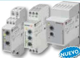
Controlador de nivel de dos puntos para dos niveles de llenado o vaciado. Ajuste de sensibilidad de 250Ω a 500KΩ. Montaje en riel DIN (CLD2) o conexión de 11 pines (CLP2). Alimentación de 24VCA/CD, 115VCA o 230VCA. El **CL2EBU** es de 240VCA/DC. Con hasta 2 salidas de 8A y LEDs diagnósticos.
