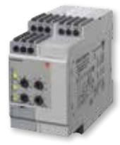
Relé de monitoreo de sobre o bajo **Cos** (**DWA**) y potencia activa **TRMS AC**. Relé de monitoreo de factor de potencia (**DWB**) para cargas balanceadas trifásicas. Versión de 11 pines **PWA** también disponibles. 480VCA máx., la corriente de monitoreo máxima se determina por el primario del MI, MP o 5A de TC secundaria.
