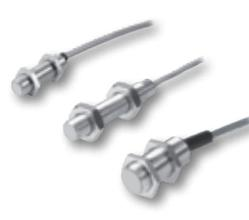
La **Serie IA..HT-K** de sensores de alta temperatura en M5, M8, M12, M18 y M30 de acero inoxidable o latón niquelado con cubiertas IP67. Resisten temperaturas de -40°C a 120°C (-40°F a 248°F). Rangos de sensado hasta de 15mm. Salida en 3 hilos CD. Montaje rasante o no-rasante. Conector M12 o 2m de cable.
