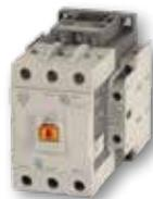
Contactores robustos de 3 y 4 polos con valores de AC3 de 9-100ACA a 480VCA, certificación cUL de 5-75Hp. Rango completo de bobinas de CA o CD. Terminales de borne o tornillo. Uno o dos sets de contactos auxiliares. Accesorios como sobrecargas, inversores, contactos auxiliares extra, y supresor de sobretensiones.
