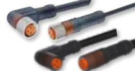
Cables PVC o PUR IP67 con conector M8 en ángulo recto o de 90°. Disponibles con 3 o 4 pines de conexión para sensores CD. Versiones de 2m, 5m, 10m o 15m. Los tipos PUR ofrecen mayor flexibilidad y resistencia a químicos abrasivos, aceites y otros lubricantes. Opción de cable con LED para sensores PNP. Conector Plus-on (**CONBP**) también disponible.
