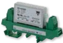
**RP1A** o **RP1B** son relés de estado sólido para montaje en PCBs, pero al ordenarse con el sufijo M1 (230VCA) o M2 (480VCA), se envían desde fábrica con un adaptador de riel DIN. Los rangos de voltaje incluyen 230VCA (12.5mm ancho) y 480VCA (25mm de ancho), valor nominal de corriente de hasta 5.5ACA.
