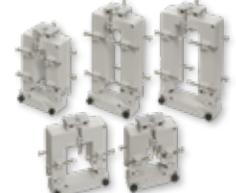
El transformador **CTD.X** de núcleo cerrado, para cable o barra bus con montaje en riel DIN / barra bus y panel. El **CTD.S** es un transformador de núcleo abierto con las mismas opciones de montaje. Corrientes primarias máximas de 1 a 4,000ACA con corrientes secundarias de 1 o 5 ACA.
