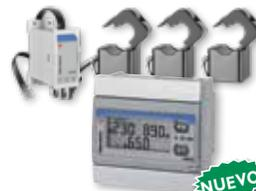
Analizador de potencia multi-circuito para 6 sistemas monofásicos o 2 trifásicos, montable en panel o riel DIN. Mide las corrientes mediante 2 grupo de transformadores de corriente de núcleo partido **TCD..M** conectados mediante adaptadores **RJ-11**. El **EM271** está equipado con un display removible, puerto **RS485** y salidas duales de pulso opcionales. Máx. voltaje de 415VLLCA.
