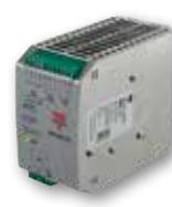
Unidad independiente UPS CD con concepto único del manejo de energía. La potencia de la carga es independiente de la batería dándole prioridad a la carga. Salida continua de 5A con hasta 10A posibles al utilizar la batería. Los bastidores para montaje riel DIN de las baterías.
