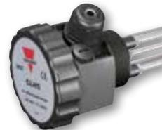
Varillas modulares de sensado de nivel para control de llenado/vaciado. Se utilizan con el controlador CLD. Se puede utilizar hasta con cinco electrodos (pueden ser aislados), con prácticamente cualquier longitud. Electrodos disponibles en Kynar (PVDF) y poliolefina (FR).
