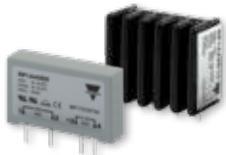
Los **RP1A** y **RP1B** son RES compactos para bases o PCBs de montaje superficial. Para CA (max 480VAC) hasta 5.5ACA o 10ACA (versiones con disipador de calor integrado). **RP1A** tiene conmutación en cero, mientras que el **RP1B** es de conmutación instantánea.
