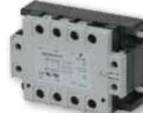
**RZ3A**: Relé ES de 3 fases, montable con disipador de calor integrado diseñado para cargas resistivas e inductivas de hasta 75 y 20ACA respectivamente a 660VCA. Los varistores integrados proporcionan protección contra voltajes transitorios en aplicaciones de uso industrial. También se ofrece protección contra sobrecalentamiento de manera opcional.
