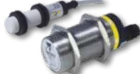
Sensores capacitivos tecnología Tripleshield™. Versiones 20-250VCA y 20-250VCA/CD (sólo M30 **CA30..CLN..CP**). Cubiertas IP67 en PBT y acero inoxidable disponibles. Sensado hasta 15mm (M18) o 25mm (M30), salidas NA y NC. Conexión por 2m de cable o conector M12. 4 hilos CD también disponibles en cubiertas de acero inoxidable (**EC30...N.ASL**)
