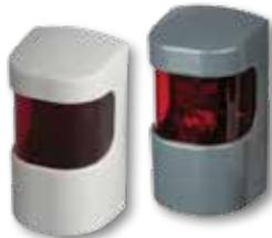
Sensor versátil retro-reflexivo polarizado desarrollado para sistemas automáticos de puertas. Cubierta IP66 plástica o en aleación metálica. Detecta en una de tres direcciones al ajustar el ángulo de sensibilidad en la cubierta. Hasta 12m de rango, alimentación de 24VCA/CD y salida a relé.
