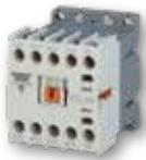
Comutación electro-mecánica de 3 fases. AC3 480VCA clasificación 6, 9 y 12 ACA. Certificación cUL hasta 7.5Hp. Un contacto auxiliar. Arreglo completo de bobinas y accesorios en CA y CD. Opciones de conexión de tornillo, muelle, conexión rápida (clip-on) y terminales de pin.
