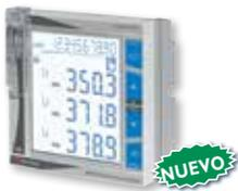
Analizador modular de potencia para sistemas trifásicos con interfaz simplificada y display de LCD. Módulos listos para usarse al conectarlos. Energía Activa y Reactiva. Módulos opcionales para el **WM20**: Modbus-RTU, TCP/IP, BACnet MS/TP o IP, Profibus y salida doble de relé. Puerto óptico integrado para conectividad OptoProg. Mediciones de hasta 690VCA.
