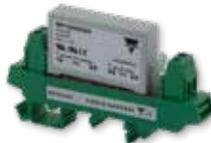
**RP1D...M1/2** es un Relé ES de CD montado en un adaptador de riel DIN. El dispositivo sirve para 1, 4 u 8ACD y hasta 60 (sufijo M1) o 350VCD (sufijo M2). El Relé RP1D es ideal para aplicaciones donde hay necesidad de conmutación rápida de pequeñas cargas de CD.
