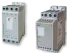
Arrancadores fáciles de usar **RSBD** (2 polos) y **RSBT** (3 polos) para compresores tipo tornillo. Ambos están equipados con algoritmos auto-adaptables patentados que automáticamente se adaptan al desempeño de cada compresor específico. **RSBD** y **RSBT** trabajan hasta 95ACA y 480VCA. Disponible Modbus RTU.
