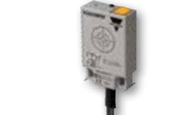
Sensores capacitivos de proximidad CD **EC55** con tecnología Tripleshield™. Distancia de detección de 4-25mm rasante y no-rasante. Salidas NPN o PNP NA/NC. 2m de cable o conector. **VC55** es un sensor básico con sensado de 2-10mm. NPN o PNP, NA o NC y 2m cable. Ideal para aplicaciones en maquinaria para plástico.
