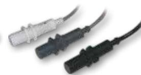
Sensores capacitivos tecnología Tripleshield™. Distancia de detección ajustable de 3-8mm (rasante) o de 3-12mm (no rasante). M18 de Polipropileno negro, PVC o teflón con 2m de cable. Ideal para su uso en aplicaciones de nivel para la industria química, de semiconductores y de alimentos-bebidas.
