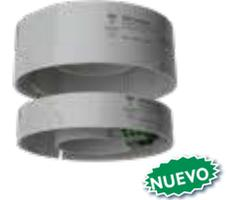
Base de soporte para sensores Carpark e indicadores LED. Para ser montado en riel, guías de montaje de techo y tubería. Ø116 x 24 mm (tipo A); Ø116 x 44 mm (tipo B). La base de soporte cuenta con terminales de cable para un cambio rápido del sensor. Chip en tablero con código SIN.
