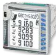
Analizador de potencia trifásico con opción de adquisición de datos. El **WM40** mide valores instantáneos, así como min y max, cuatro cuadrantes de energía y análisis de armónicos. Comunicación opcional: igual al WM30, salidas de relé y análogas, procesamiento de temperatura y entradas. Mide hasta 690VCA.
