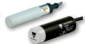
Sensores capacitivos con aprobación ATEX en CD o CA (Tripleshield™). Distancias de detección de hasta 12mm (Ø18) o 20mm (Ø32), montaje no rasante. Salidas NA o NC con retardos a la entrada o salida (modelos CA), PNP o NPN con salida NA o NC (modelos CD). Ideales para detección de granos o sólidos en tanques, silos o contenedores en zonas ATEX 200 o 22.
