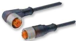
Cables IP67 de PVC o PUR, disponibles en ángulo recto y 90° con conector M12. Versiones de 3, 4 o 5 hilos para sensores de CD. Disponibles en 2m, 5m, 10m y 15m. Los tipos PUR otorgan mejor flexibilidad y resistencia a químicos, aceites y otros lubricantes. Algunos modelos incluyen LEDs.
