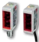
Sensores compactos de rango completo con cubierta reforzada de plástico. La solución ideal cuando se requiere de alta precisión en la detección y tamaño compacto. Ajuste por potenciómetro superior o posterior. Disponible en versión difusa (1m), retro-reflexiva (6m), barrera (15m) y polarizada (6m). Supresión de fondo (200mm). También con versión para detección de objetos transparentes.
