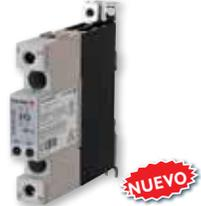
**RGC1A...32** relé mini 17.5 ofrece corrientes de conmutación que normalmente se usan en relés de 22.5mm o incluso de 45mm de ancho. Dos terminales de salida están disponibles, tornillo o clema, con sus respectivos valores de corriente de 30A o 37ACA a 40°C. I2t de 18,000 A2s es estándar en todos los modelos **RGC1A...32**
