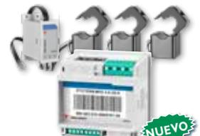
Analizador de potencia multi-circuito para sistemas monofásicos o trifásicos, montable en panel o riel DIN. Mide las corrientes mediante 2 grupos de transformadores de corriente de núcleo partido **TCD..M**. El **ET272** está equipado con dos puertos RS485 para conexión margarita. Diseñado para aplicaciones de alto volumen. Máx. Voltaje 415VLLCA.
