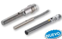
Sensores de proximidad inductivos miniatura con rangos de sensado de hasta 1.3mm. Tres hilos de CD. Cuerda M5, barril liso para 4mm y 6.5mm. Cuerpo de acero inoxidable IP67. Montaje rasante o no-rasante. Velocidad de 6KHz. Versiones IO-Link de estos sensores se muestran en la pág. 11.
