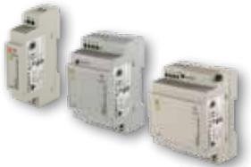
Estas fuentes de poder de bajo perfil con profundidad de 2.2". Salidas de potencia de 7.5, 10, 15, 25, 30, 35, 54, 60, 72, 91 Y 100W en voltajes de 5, 12, 15 y 24VCD. La mayoría de los modelos cumplen con UL1310 Class 2.
