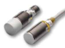
Sensor inductivo de proximidad M18 en acero inoxidable, latón niquelado o plástico con cubierta IP67. Versión estándar y de rango extendido hasta 14mm de sensado. Salidas NAMUR, 2 hilos CA, 2 hilos CD y 3 hilos CD. Montajes rasante, cuasi-rasante y no rasante. Método de conexión: cable 2m o conector M12. Versiones IO-Link de estos sensores se muestran en la pág. 11.
